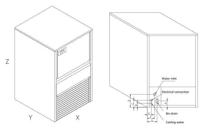
$<sup>^{\</sup>ast}$  HEIGHT Z REPRESENTS MINIMUM MACHINE HEIGHT. IF LEGS ARE PLACED UNDER MACHINE, IT INCREASES 80 MM.  $^{\ast}$
